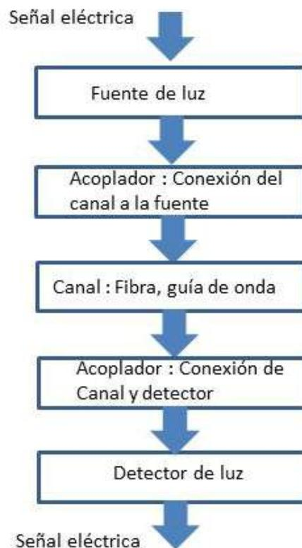
Fig. 5. Diagrama de bloques de un Sistema óptico de comunicaciones.
