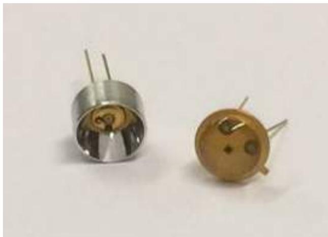
Fig. 10. LEDs Infrarrojos.
